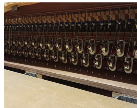
Blick in eine geöffnete Windlade: Alle Tonventile wurden zu Wartungszwecken ausgebaut...
