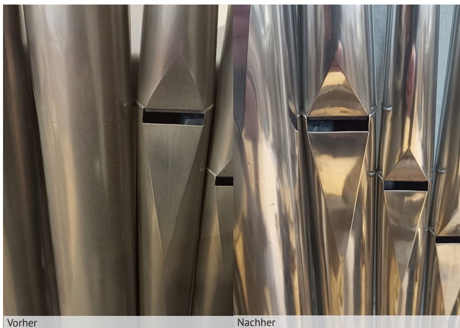
Die Prospekt Pfeifen der mittleren Pfeifenfelder, die in der Schauseite der Orgel stehen, werden nicht nur gereinigt, sondern auch poliert.
